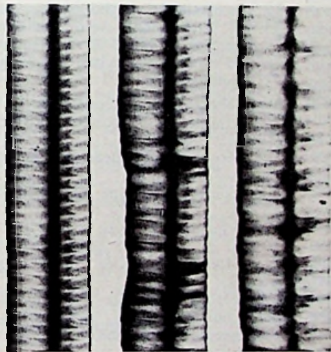
Fig. 5. Het frequentiespectrum van de informatie in de ambiogrammofoonplaat.
